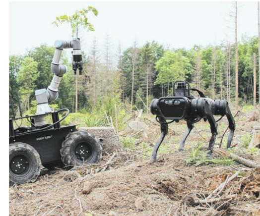
Roboter des Autonomously Mobile Robotics Lab (AMRL) sollen beim Aufforsten an steilen Hängen helfen, wo es für Menschen zu gefährlich ist
